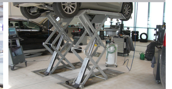
JUMBO LIFT 4000 NT – Aufnahmebereich für Fahrzeuge ähnlich VW T5 mit kurzem Radstand | Entwickelt für Sonder-schutz-Pkw | Für den bodenebenen Einbau
