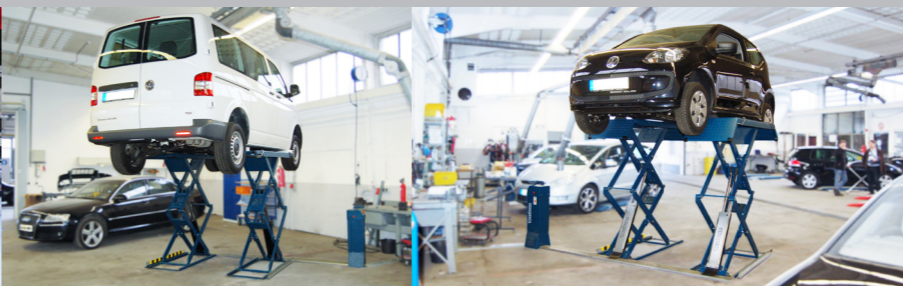
JUMBO LIFT 3500 NT – Aufnahmebereich für Fahrzeuge ähnlich VW T5 mit kurzem Radstand | Optional bodenebene und bodenaufbauende Installation
